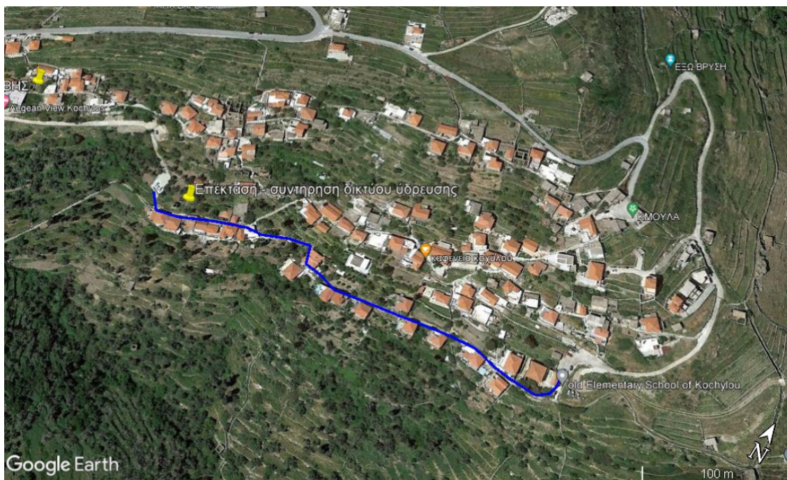
Φωτ. 1. Αντικατάσταση αγωγού ύδρευσης στην Κοιν. Κοχύλου
